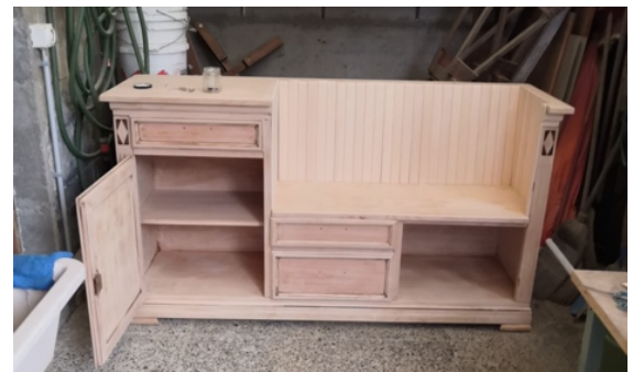
Abbildung 20: Vollständig abgeschliffenes Möbel, mit Einblick auf das ebenfalls vollständig abgeschliffene Innere, (eigene Aufnahme)
