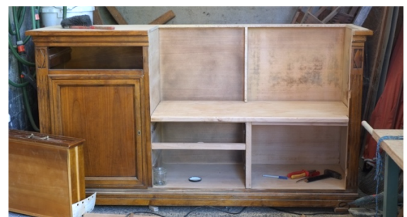
Abbildung 14: Das Möbel mit der befestigten Sitzplatte, (eigene Aufnahme)
