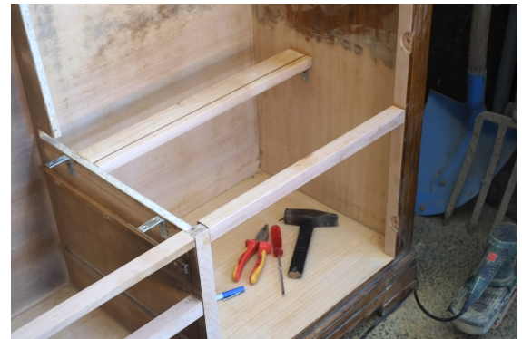
Abbildung 12: Verstärkungen, damit man sich auch tatsächlich auf die Sitzbank setzen kann, (eigene Aufnahme)
